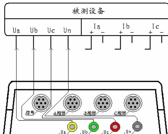
电压谐波测试接线图
