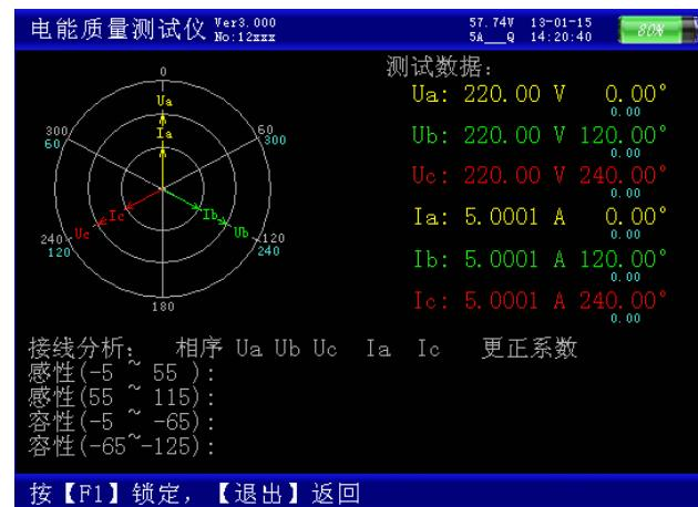
容、感性关系，上图所示为标准阻性负载时接线全部正确情况下的三相四线向量图。按 F1 键能将屏幕锁定，便于读数，按 F2 继续刷新。按 F3 键能返回主菜单。
